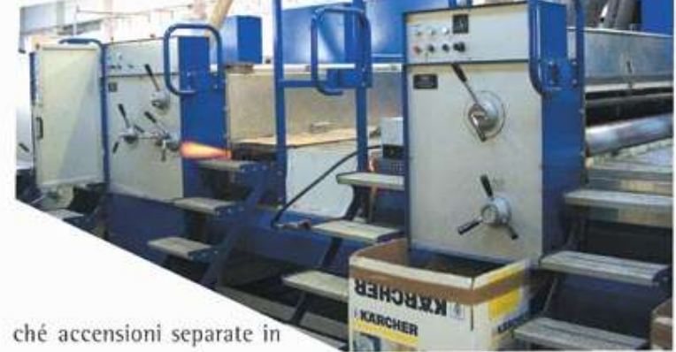
La linea Emba equipaggiata con forni IR ventilati Giardina
